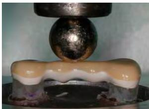
Montaggio di prova con campioni standardizzati dell'Università di Regensburg<sup>e)</sup>
