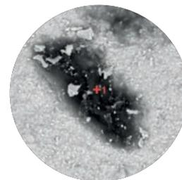
Composizione dei residui di sporco sugli abutment in zirconio, realizzati con tecnica CAD-/CAM
